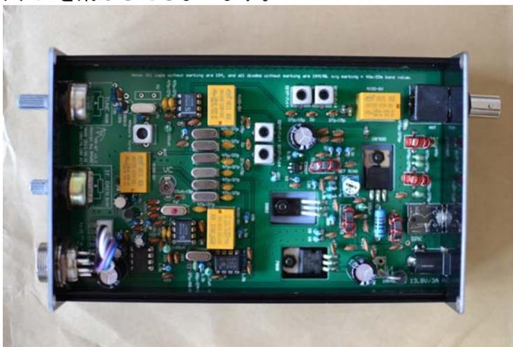
ケースを閉じてパネルをネジ止めしノブを取付 BNC コネクタにはワッシャを取り付けてください。完成です。 QRP 運用を自分の作った無線機で楽しんでください。
